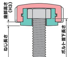
※使用時のねじ長さは使用ボルトの首下長さから座部高さを引いたものとなります。
