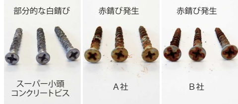
比較試験：①適正下穴をあげビスを先端 20 mmまで打込み引抜きます。 ②240時間の塩水噴霧試験をかけます。
